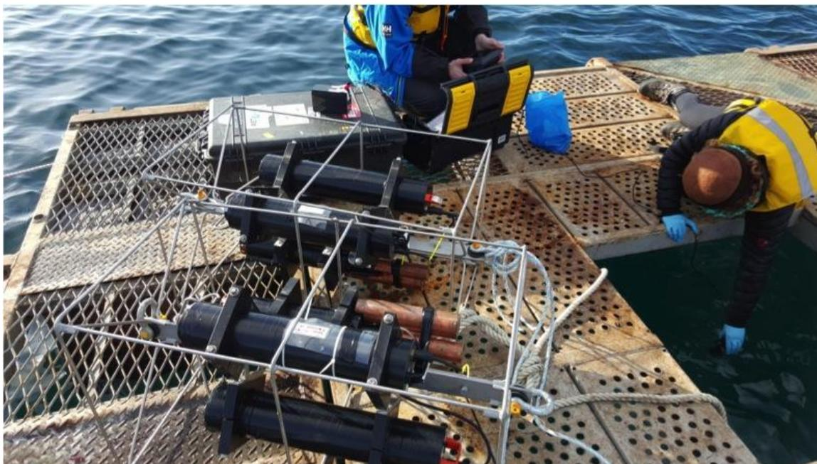
**Figura 3. Sistema de observación de pH utilizando un sensor SeaFET®, acoplado a un WQM e instalado en una plataforma en la región sur de Chile (cortesía Centro MUSELS).**
